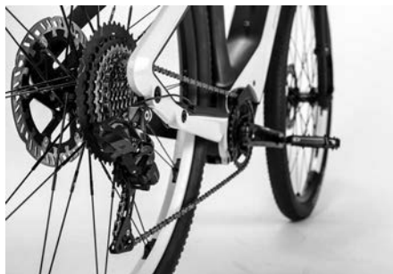
Fig. 18: Chaîne sur plateau / cassette arrière
