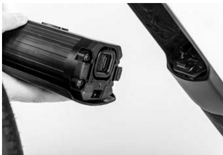
Fig. 32: Montage de la batterie de transmission
