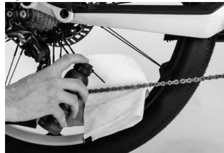
Fig. 21: Graisser la chaîne
