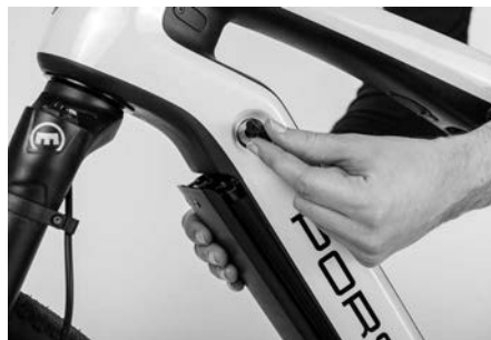
Fig. 33: Blocage de la batterie de transmission
