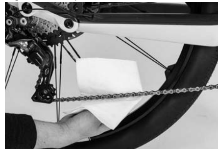
Fig. 21: Graisser la chaîne
