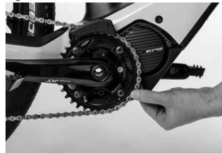
Fig. 22: Contrôler l'état de la chaîne
