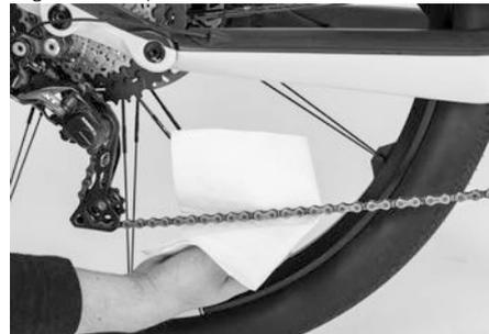
Fig. 21: Lubricar la cadena
