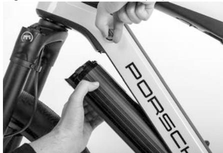
Fig. 31: Extraer la batería de propulsión
