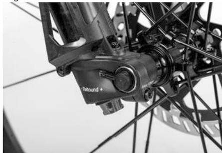
La rueda delantera de la PORSCHE eBike Cross posee una unión roscada del eje sin herramienta. Abra el cierre rápido en el eje de tornillo e introduzca el eje ligeramente lubricado por el buje hasta la rosca de la puntera. Gire el eje para apretar y genere el pretensado moviendo la palanca de cierre rápido 90° hacia arriba.
