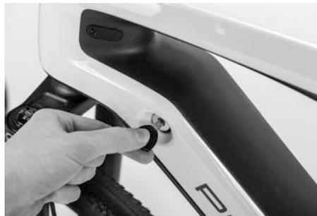
La batería de propulsión se suelta del cierre de la batería de propulsión en el tubo inferior. Una placa doble de cierre mantiene la batería de propulsión en posición y evita que se caiga. Presione la placa doble de cierre y saque la batería de propulsión de la eBike.
