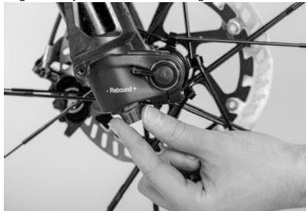
Una amortiguación demasiado escasa provoca una expansión muy rápida de la horquilla. Una amortiguación demasiado rígida provoca que la horquilla de la suspensión se hunda en caso de muchos baches seguidos, ya que no puede expandirse suficientemente rápido.
