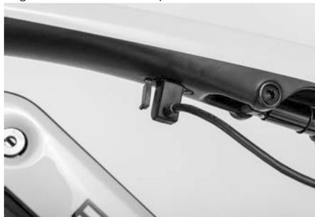
La carga comienza automáticamente. La indicación de estado de carga parpadeando indica que el proceso de carga está en curso. El cargador indica que la carga está en curso con una luz LED.
