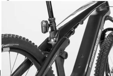
Ambas luces se entregan con los tornillos correspondientes. Dichos tornillos se aprietan con un par de 4 Nm.
