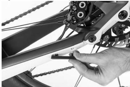
Para montar la pata de cabra, sosténgala contra la cavidad diseñada para ella en el lado interior de la vaina inferior.
