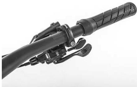
Fig. 24: Posición de la maneta de cambio (electrónica)
