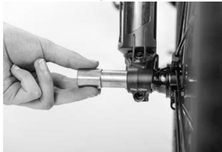
La rueda delantera de la PORSCHE eBike Sport posee una unión roscada del eje con herramienta. Se necesita una llave torx (tamaño T25). Antes del montaje, asegúrese de que la rosca no presenta suciedad ni daños. Meta el eje de inserción ligeramente lubricado desde la derecha hasta el tope a través de las punteras y el buje.
