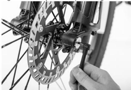
Fig. 51: Montar los tornillos de sujeción
