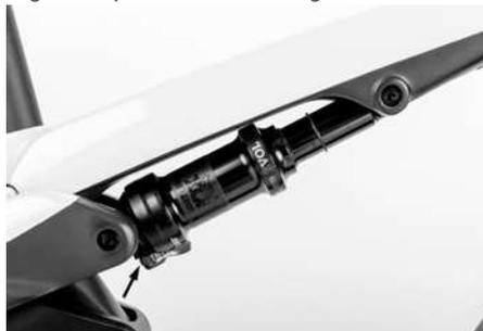
Para un ajuste correcto, el primer paso es girar la rueda de ajuste en el sentido contrario a las agujas del reloj hasta el tope. A con-
