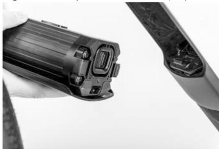
Por último, asegure la batería de propulsión en el tubo inferior. Para ello, inserte la llave en el cilindro de cierre del soporte de la ba-
