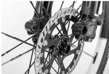
En las ruedas delanteras de las PORSCHE eBike se utilizan ejes de tornillo. Al colocar el buje de la rueda delantera, preste atención a que el buje esté firmemente asentado en las punteras y que el disco de freno esté centrado correctamente en la pinza de freno.
