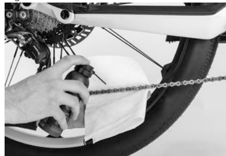
Fig. 21: Graisser la chaîne
