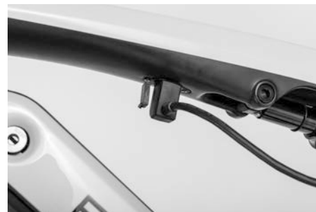
Fig. 7: Câble de chargement fiche / batterie de transmission
