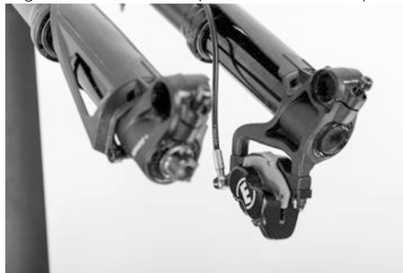
Fig. 64: Cale de transport du frein à disques
