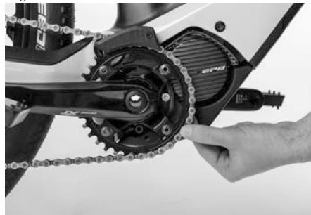
Fig. 22: Contrôler l'état de la chaîne
