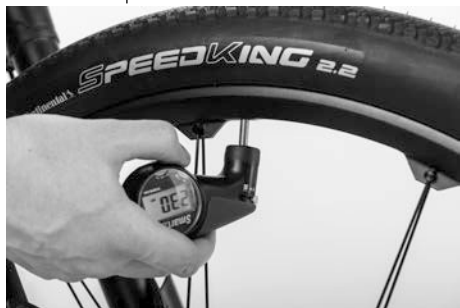
Fig. 12: Contrôler la pression de gonflage des pneus
