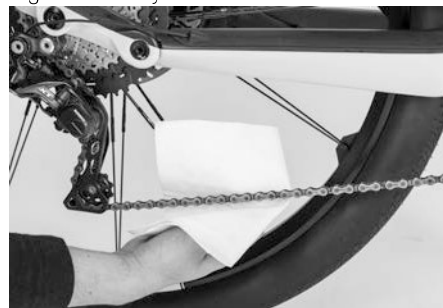
Fig. 21: Graisser la chaîne
