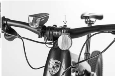
Fig. 62: Montage du réflecteur avant
