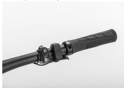
Fig. 24: Posizione della leva del cambio (elettronico)
