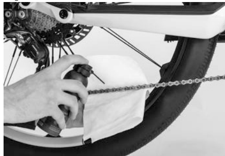
Fig. 21: Lubrificazione della catena
