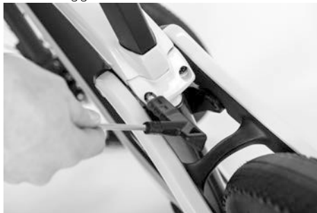
Fig. 10: Controllo delle viti di bloccaggio del reggisella
