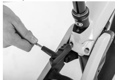
Fig. 41: Viti di bloccaggio / reggisella Dropper
