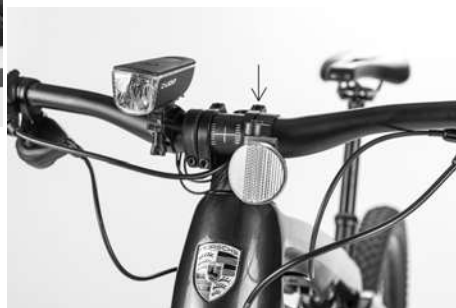
Fig. 62: Montaggio del catarifrangente anteriore
