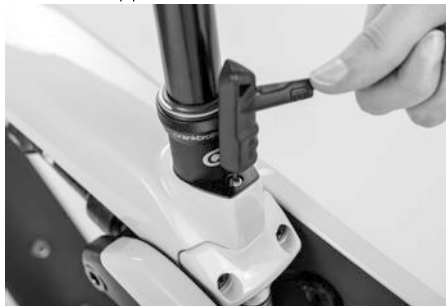
Fig. 42: Collegamento a cuneo / reggisella Dropper
