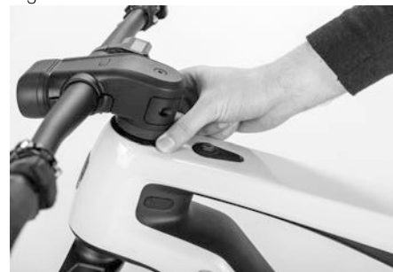
Fig. 36: Gioco della serie sterzo
