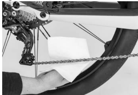
Fig. 21: Lubrificazione della catena
