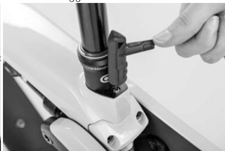
Fig. 11: Controllo del collegamento a cuneo del reggisella
