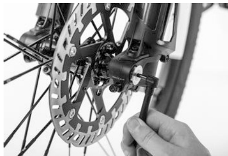
Fig. 50: Montaggio del cappuccio di sicurezza
