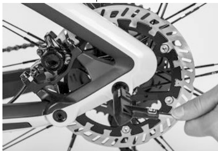
Fig. 54: Montaggio del sistema dell'asse della ruota posteriore
