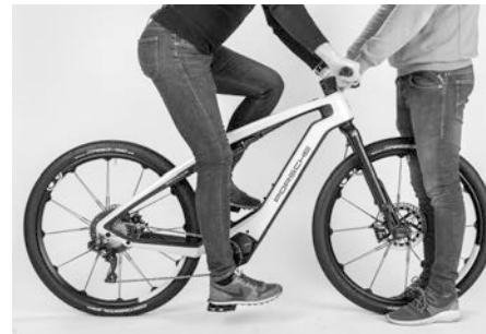
Fig. 38: Determinazione dell'altezza corretta della sella
