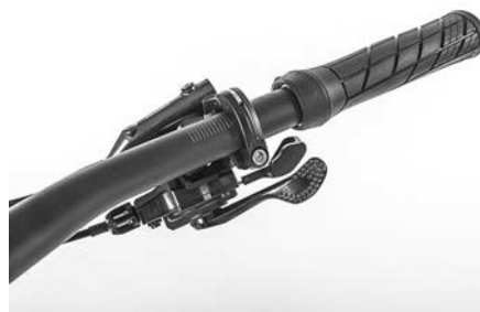
Fig. 24: Posizione della leva del cambio (elettronico)
