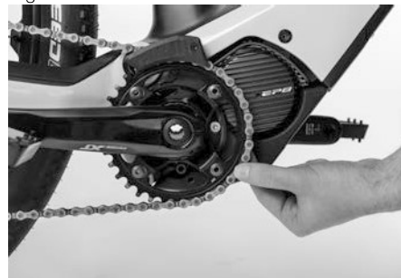
Fig. 22: Verificare le condizioni della catena
