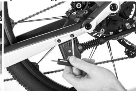
Fig. 57: Montaggio del cavalletto
