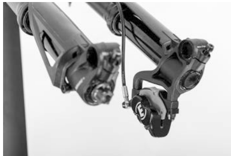
Fig. 64: Protezione per il trasporto del freno a disco
