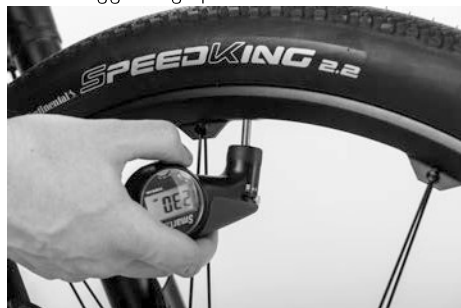
Fig. 12: Controllo della pressione di gonfiaggio degli pneumatici
