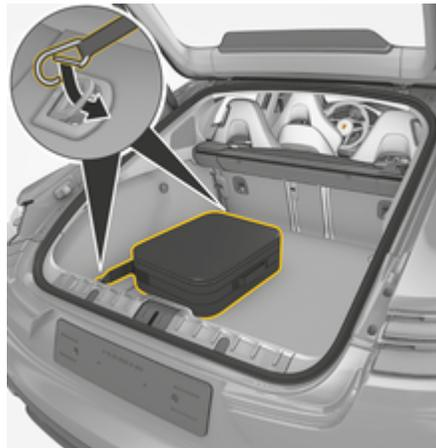
Fig. 10: Fijación del maletín (ejemplo Panamera 4 E-Hybrid)
